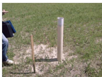
Рисунок 5 – Наблюдательная скважина, обложенная полимерной трубкой
