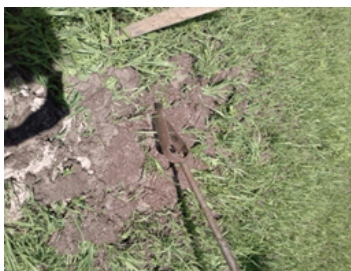
Рисунок 3 – Бур для очистки наблюдательной скважины
