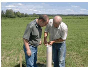
Рисунок 7 – Измерение уровня грунтовых вод с помощью хлопушки
