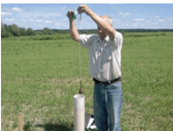
Рисунок 6 – Погружение хлопушки в скважину
