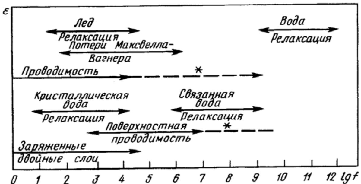
Рис.2 – Источники диэлектрических потерь в гетерогенных смесях
