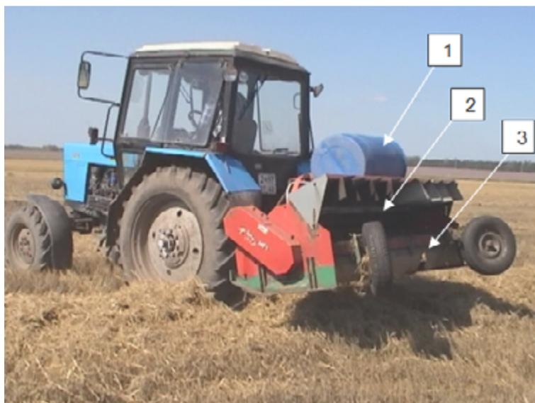
1 – бак для рабочего раствора; 2 – форсуночная рампа; 3 – измельчитель-мульчировщик Kverneland fx 230
