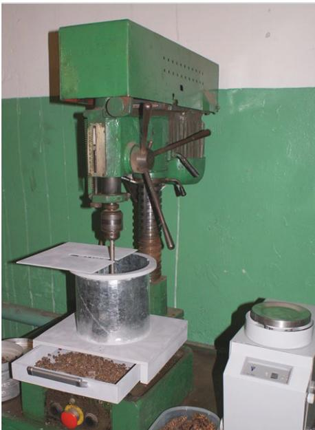
Рис. 2 – Общий вид лабораторной установки во время эксперимента вместе с ситовым рассевом и весами ВЛТК-500М
