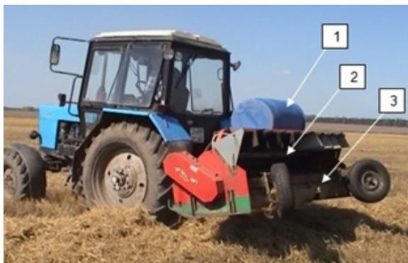
1 – бак для рабочего раствора; 2 – форсуночная рампа; 3 – измельчитель-мульчировщик Kverneland fx 230.
