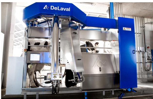
Рис. 1– Доение коров роботом-дояром фирмы «ДеЛаваль»
