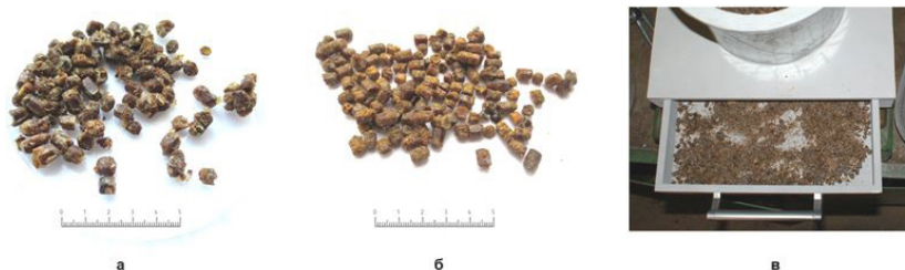
а – гранулы перги до очистки; б – очищенные гранулы перги; в – скопившиеся в лотке загрязнения Рис. 2 – Результат механической очистки перговых гранул от органических оболочек
