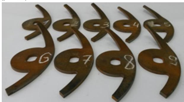
Рис. 4 –Ворошители с разными углами подъема и поворота лопасти
