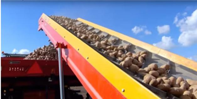
Рис. 2 – Загрузка клубней в сажалку с помощью транспортёра, прицепленного к автомобилю с подвижным дном в кузове
