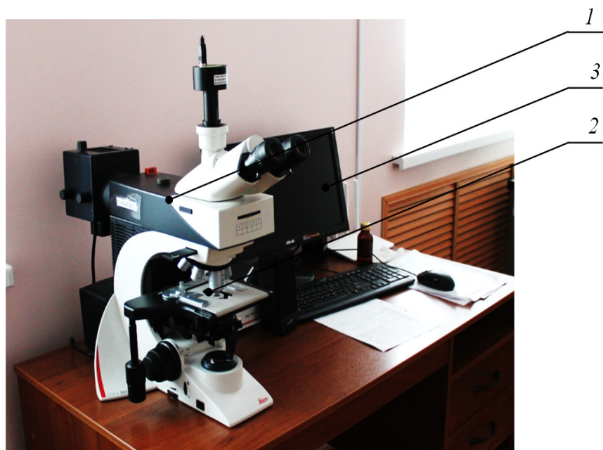
1 — микроскоп Leica DM 2500, 2- образец помета, 3 – компьютер
