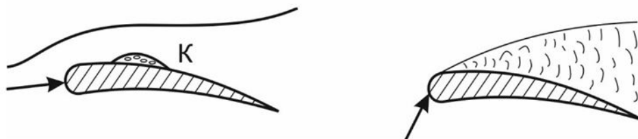
Рис. 2 – Кавитационные явления при обтекании лопастей осевых насосов и корабельных гребных винтов
