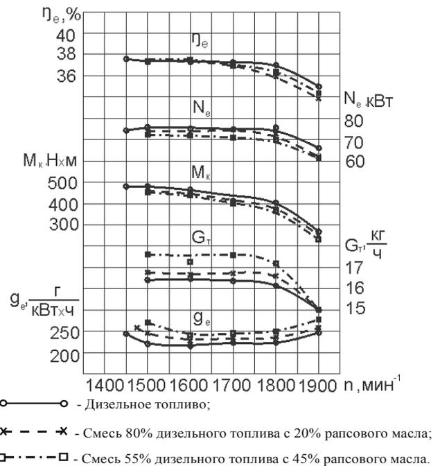
Рис. 1 – Скоростная характеристика дизеля 4ЧН 11,0/12,5 при
