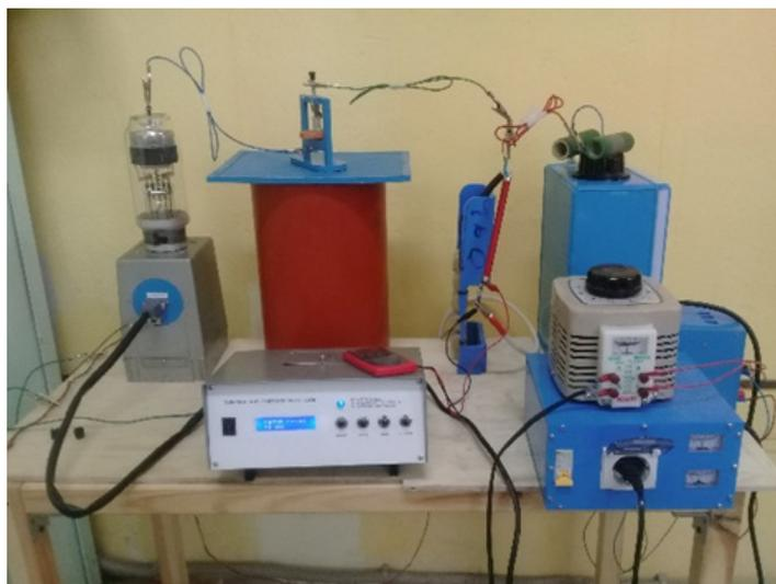
Рис. 1 – Схема экспериментальной установки для изучения процесса обработки импульсами высокого напряжения растительного сырья
