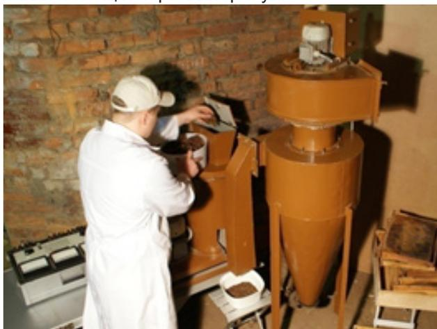
Рис. 2 – Установка для извлечения перги из сотов: измельчитель перговых сотов, снабженный циклоном и аспирационным каналом (патенты РФ на изобретение №2412590, №2275800, патент РФ на полезную модель № 93302)
