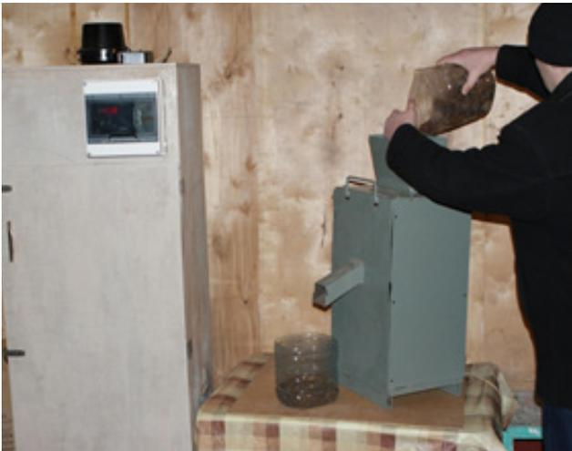
Рис. 1 – Извлечение перги из сотов в условиях пасеки при использовании установки для сушки перги и установки для измельчения перги из перговых сотов
