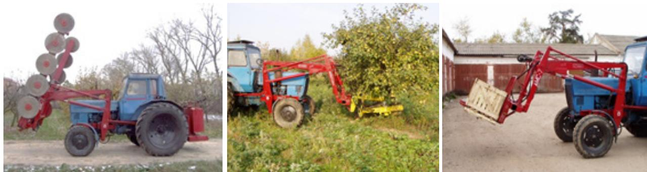
Рис. 7 – Общий вид МТЗ-80 с АМС-7: машина для контурной обрезки (слева); встряхиватель (в середине); вильчатый захват (справа).
