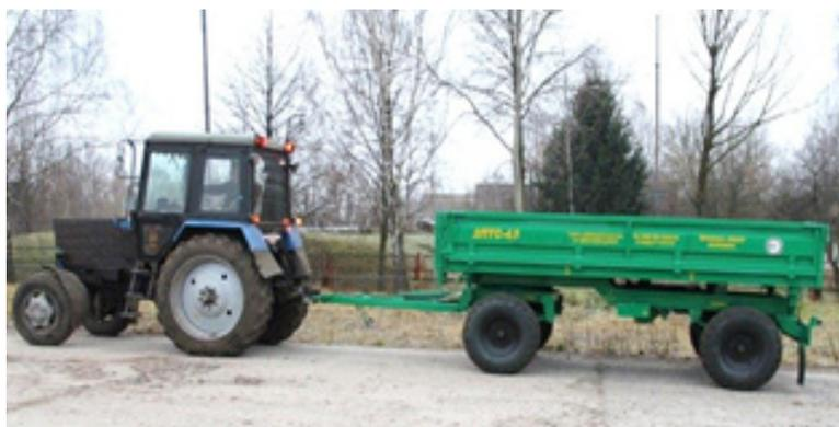
Рис. 3 – Тракторно-транспортный агрегат в составе МТЗ-82 и прицепа 2ПТС-4,5
