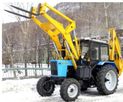
Рис. 4 – Трактор МТЗ-82, агрегатированный вилочным погрузчиком 3В-01
