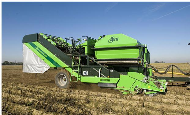
Рис. 2 – Прицепной двухрядный картофелеуборочный комбайн бункерного типа Spirit 6200
