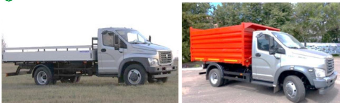
Рис. 6 – Бортовой грузовик ГАЗ С41R33 (слева), самосвал ГАЗ-СА3-2507 (справа)
