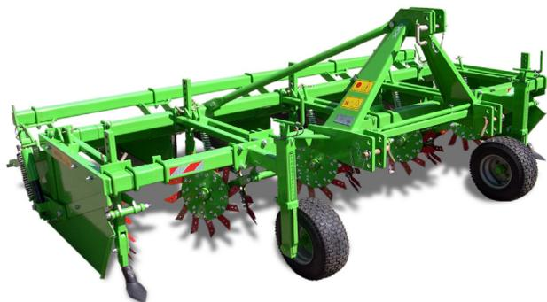
Рис. 1 – Культиватор для междурядных обработок и посадок картофеля КГП-4
