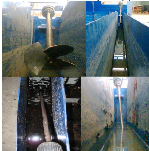
Рис. 2 – Общий вид лабораторной модельной установки. Для измерения частоты вращения вала использовался электронный бесконтактный тахометр DeLaval VPR100.
