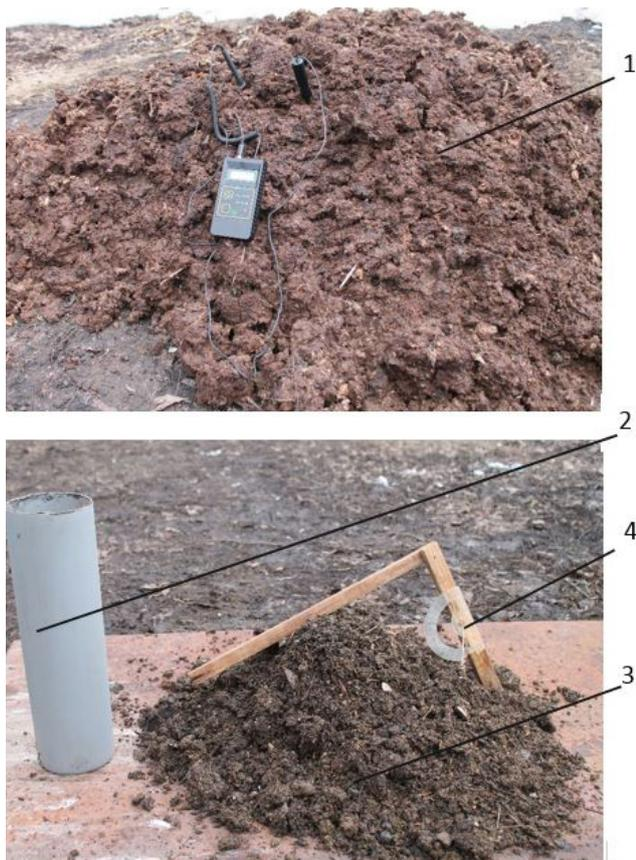
1 – бурт помета, 2 – короб, 3 – горка помета после процесса формовки, 4 – угломер
