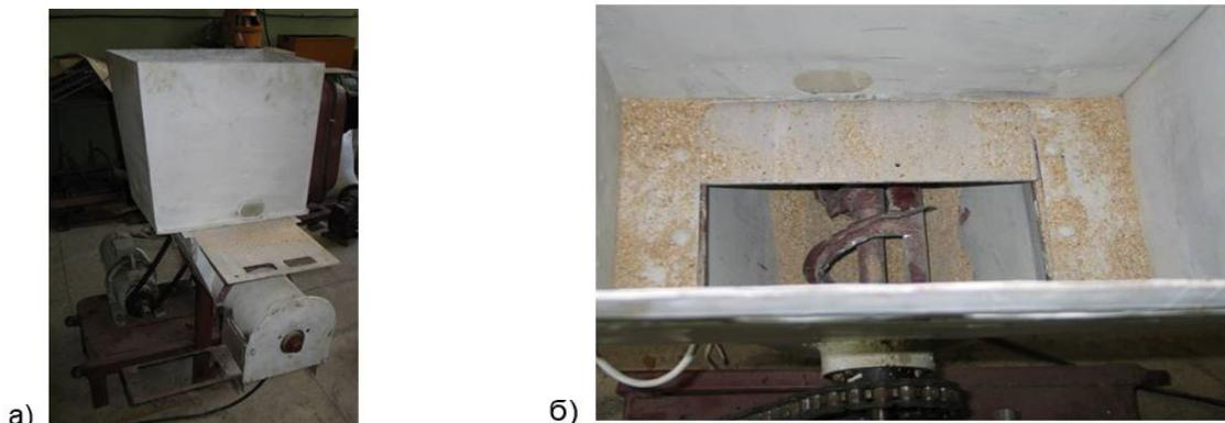
а) общий вид дозатора; б) вид загрузочного окна
