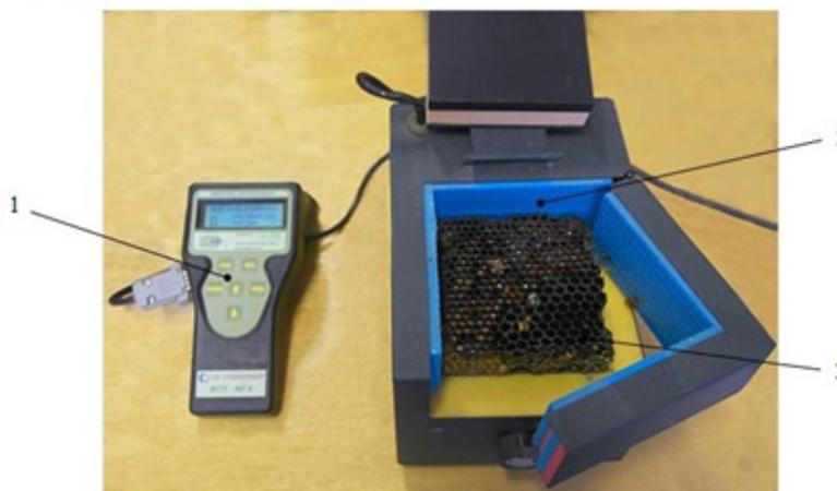
1 – электронный блок; 2 – испытательная камера; 3 – исследуемый материал
