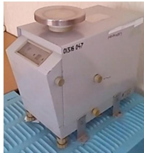
Рис. 1 – Электровлагомер типа ВЗМ-1 № 80110
