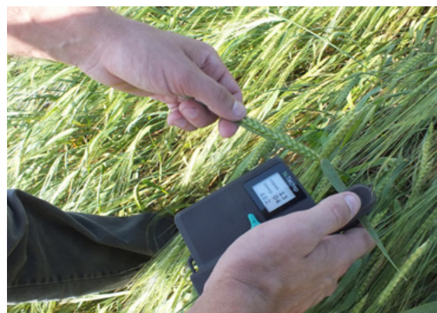
Рис. 1 – Измерение количества хлорофилла в растении при помощи прибора «N-тестер» на яровом ячмене
