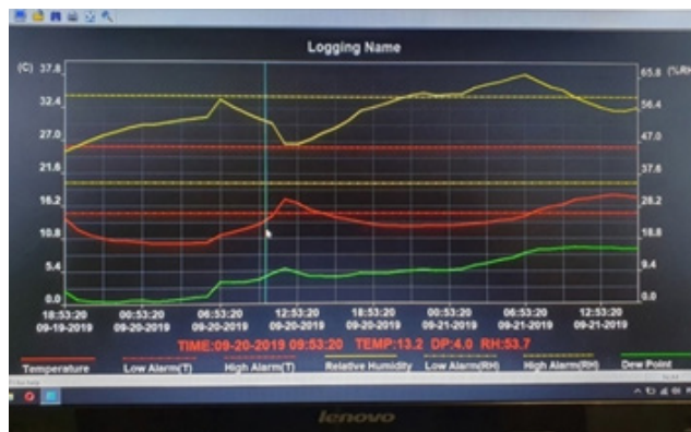
Рис.2 – Экран персонального компьютера с полученными результатами натурных испытаний (Personal computer screen with the obtained results of field tests)
