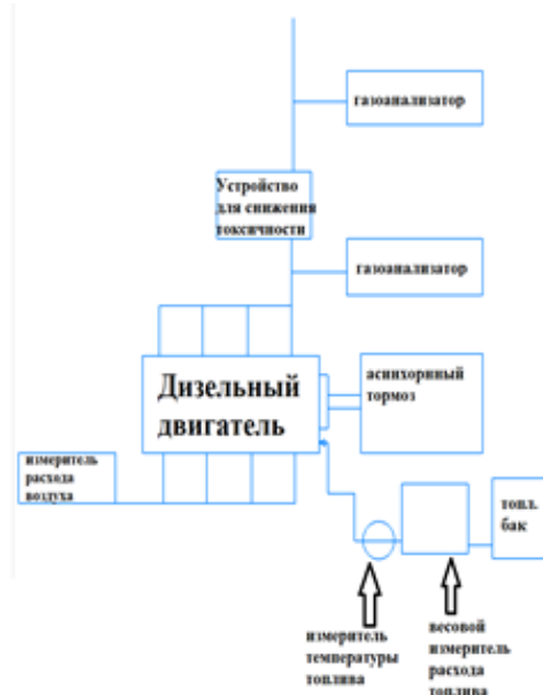
Рис. 2 – Схема экспериментальной установки (Scheme of the experimental installation)
