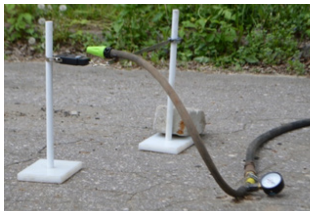
Рис. 3 – Общий вид лабораторного стенда по определению величины реактивной силы (General view of the laboratory stand for determining the magnitude of the reactive force)
