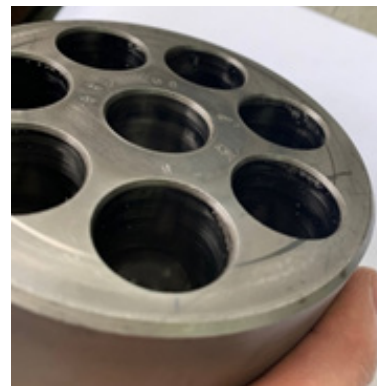
Рис. 4 – Задиры на отверстиях блока цилиндров (Bullies on cylinder block holes)
