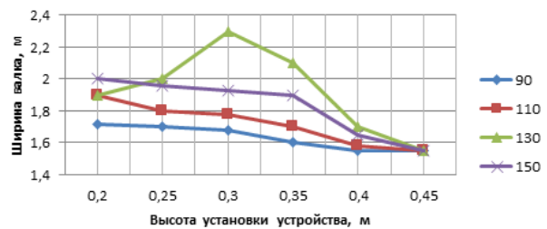
Рис. 5 – Зависимость ширины валка от высоты установки разравнивающего устройства при скорости 8 км/ч (Dependence of the swath width on the installation height of the screed, at a speed of 8 km/h)
