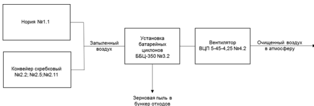
Рис. 3 – Схема движения воздушной массы в аспирационной установке №2 (табл. 1) (Diagram of the movement of the air mass in the aspiration unit No. 2 (Table 1))
