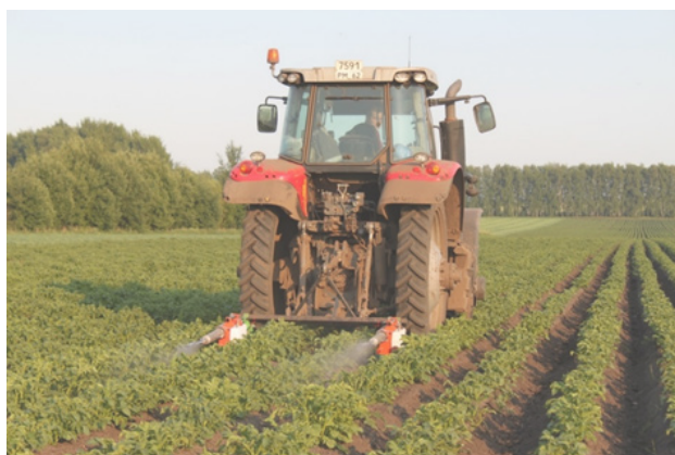
Рис. 2 – Общий вид устройства для обработки посадок картофеля горячим туманом биопрепаратов (General view of a device for processing potato plantings with a hot mist of biological products)
