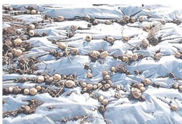
Рис. 5 – Ворох, сошедший с пруткового элеватора серийно выпускаемой машины (а) и усовершенствованной (б) (Fig.5 –The heap, descended from the rod elevator of a series-produced machine (a) and an improved
