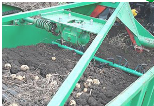
Рис.4 – Разработанный рыхлитель клубненосного пласта (Fig.4–The developed tuberous layer ripper)
