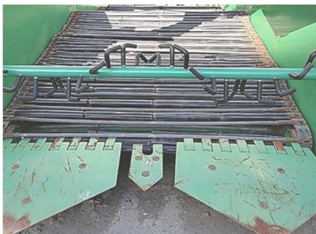
Рис. 2 – Рыхлитель клубненосного пласта, установленный на картофелекопатель КТН-2В (Fig.2 – The tuberous layer ripper installed on the KTN-2V potato digger)
