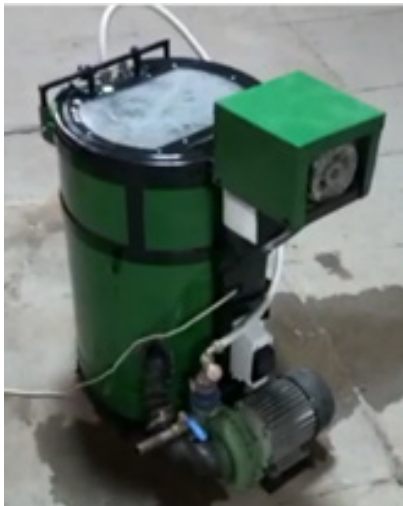
Рис. 1 – Установка для мойки деталей собственного изготовления (Fig.1 – Installation for washing parts of our own production)
