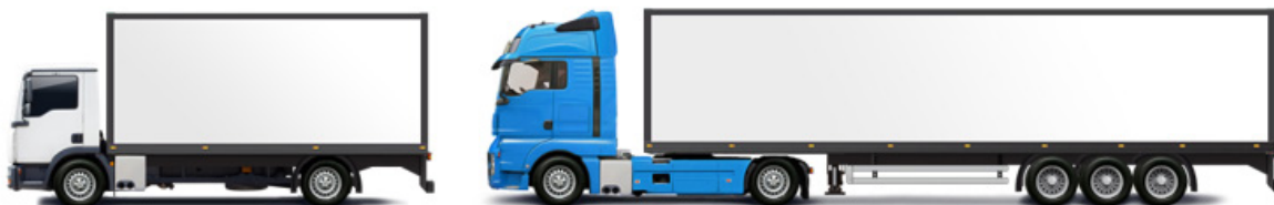
Рис. 3 – Примеры автотранспортных грузовых средств для перевозки продукции с грузовым отсеком типа термофургон/изотермический фургон или рефрижератор (Fig. 3 - Examples of road freight vehicles for the transport of products from the cargo compartment of the type of thermal van / isothermal van or refrigerator)
