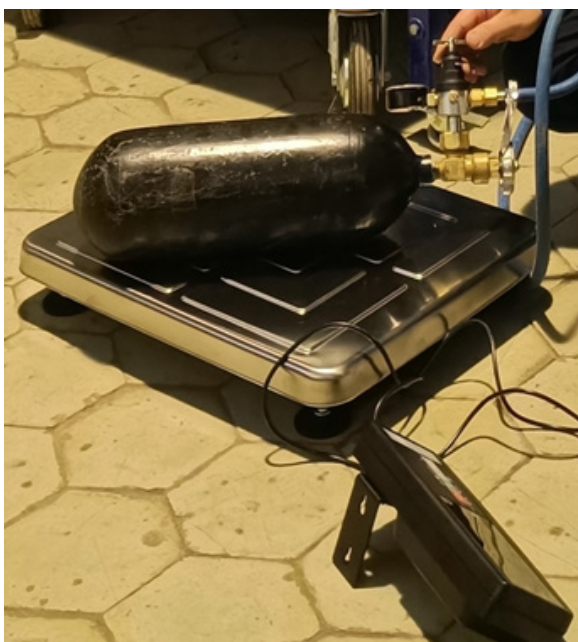
Рис. 3 – Контроль расхода углекислого газа при загрузке мягкого контейнера с комбикормом Fig 3 – Control of the consumption of carbon dioxide when loading a soft container with compound feed
