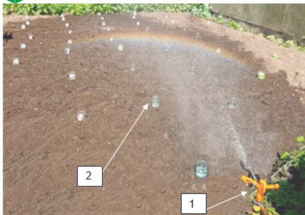
1 – разбрызгиватель; 2 – дождемеры 1 - sprinkler; 2 - rain gauges;
