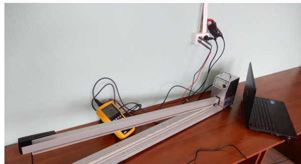
Рис. 4 – Контроль расхода потребляемой запаивателем мощности при загрузке мягкого контейнера с комбикормом
