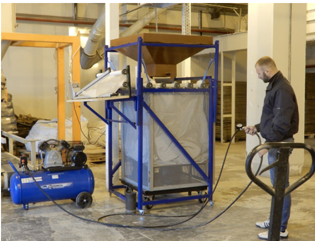
Рис. 1 – Общий вид установки для упаковки комбикормов, снабженной устройством для подачи газа в мягкие контейнеры с комбикормом Fig. 1 – General view of the installation for packaging feed, equipped with a device for supplying gas to soft containers with feed
