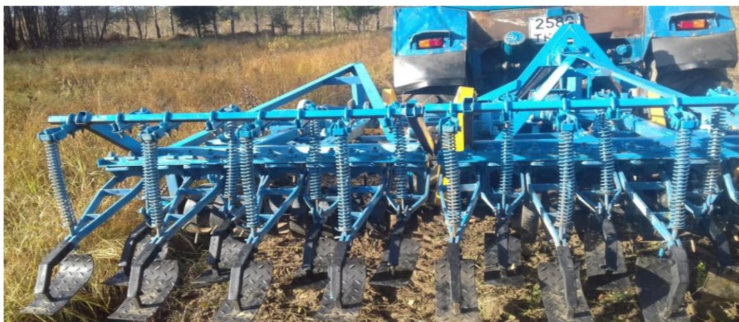
Рис. 4 – Блок выравнивателей в составе блочно-модульного комбинированного агрегата для комплексной предпосевной обработки почвы
