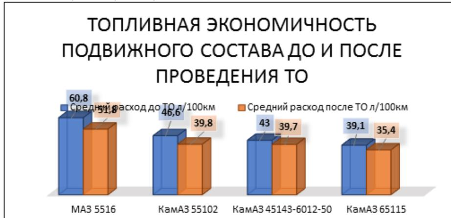
Рис.2 – Топливная экономичность подвижного состава до и после проведения ТО.
