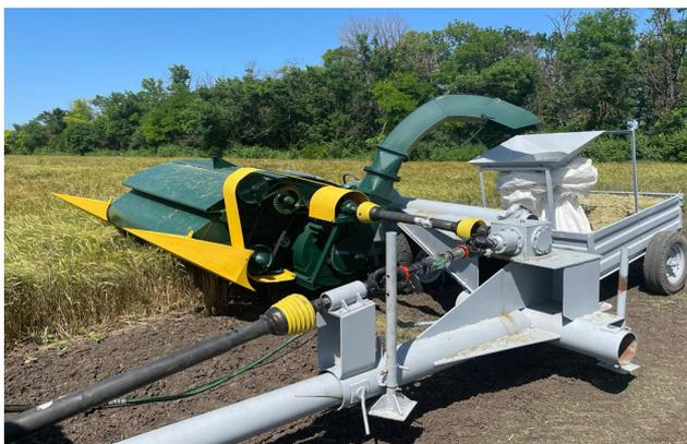
Рис. 1 – Очёсывающе-обмолачивающий агрегат для уборки зерновых колосовых культур
