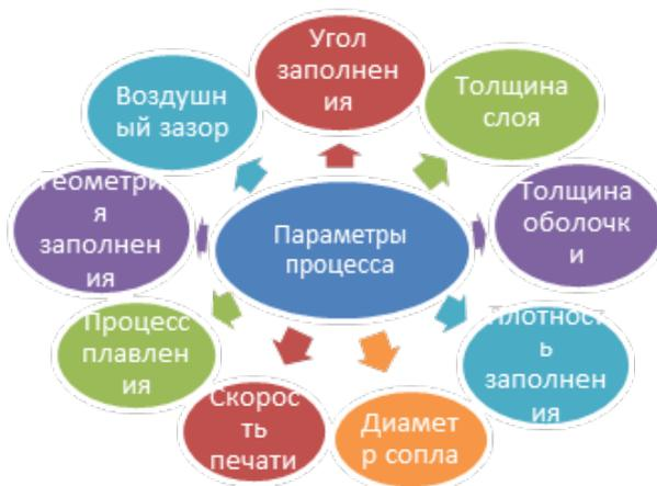
Рис. 4 – Параметры процессов FDM
