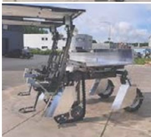
Рис. 8 – Селекционная машина «AARDAPPEL SELECTIEWAGENS» компании «Gercon» (Нидерланды)
