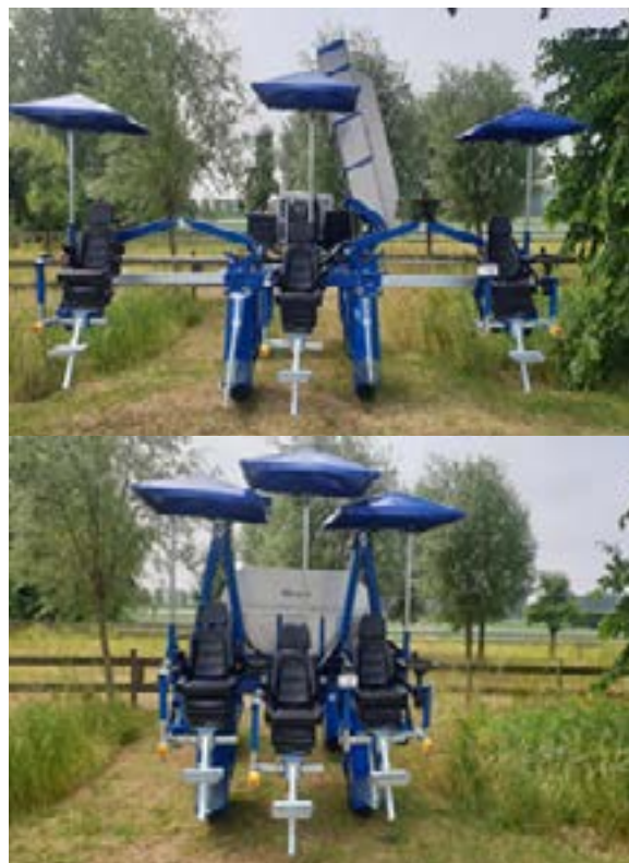
Рис. 10 – Селекционная машина «VSS Agro Roguing Cart» (Нидерланды)
