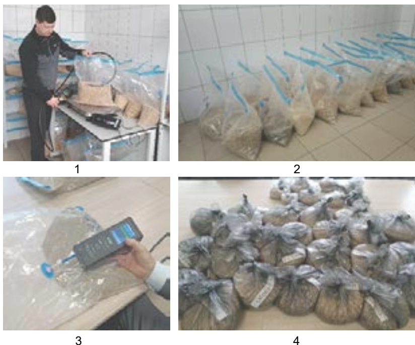
1 – упаковка продукта в газовой среде; 2 – хранение продукта в газовой среде; 3 – анализ состояния газовой среды в контейнере; 4 – пробы для анализа в лаборатории
