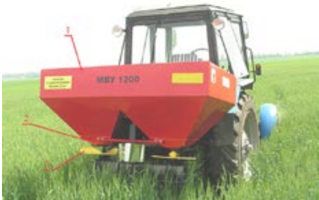
1 – бункер; 2 – разгрузочные отверстия (заслонки); 3 – два диска, один из которых вращается по часовой стрелке, другой – против часовой стрелки
