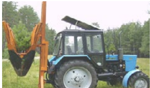
Рис. 6 – Манипулятор для пересадки деревьев на базе трактора МТЗ 82 [15] Fig. 6 – Manipulator for transplanting trees based on MTZ 82 tractor
