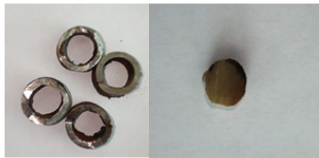
а – поперечный распил металлического замка; б – поперечный распил композитного прутка Рис. 4 – Вид экспериментальных образцов после осуществления распилов
