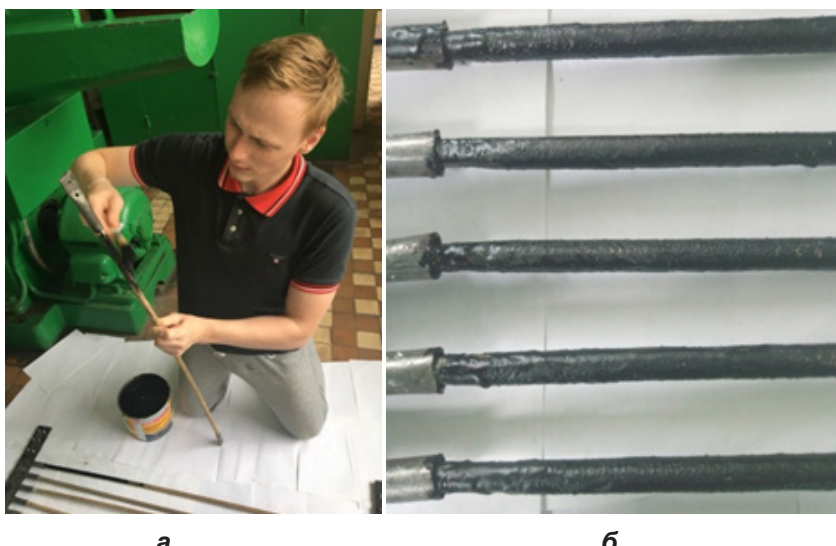
а – нанесение гидроизоляционной мастики, б – композитные прутки покрытые гидроизоляционной мастикой Рис. 2 – Композитные прутки сепарирующего элеватора картофелеуборочных машин
