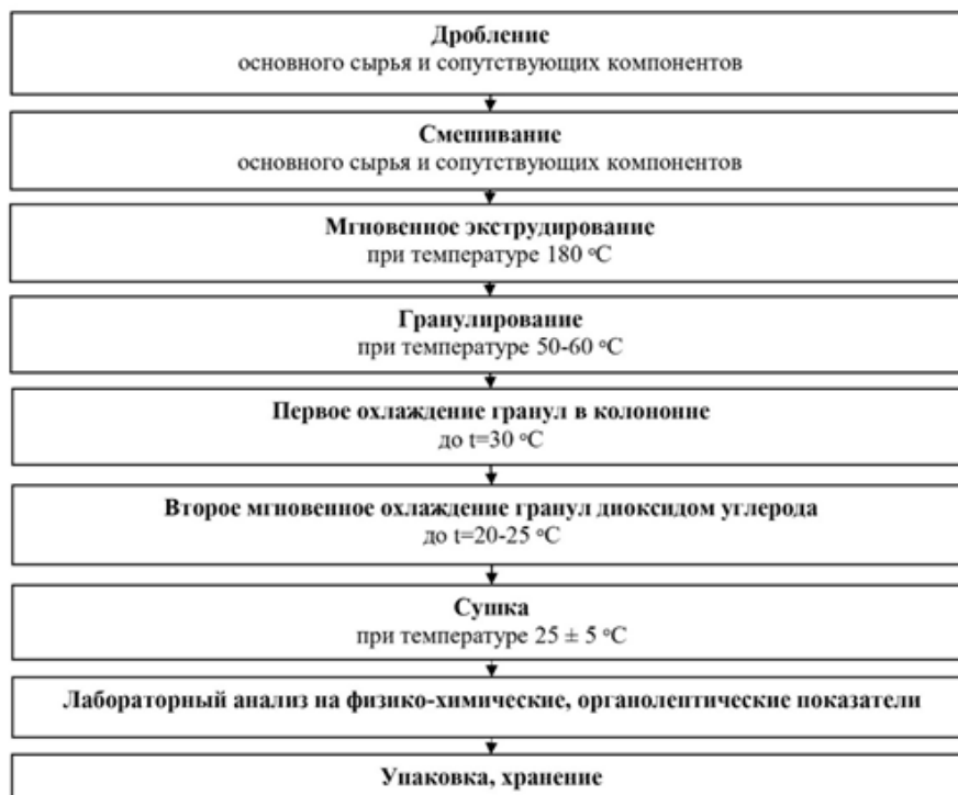
Рис. – Схема производства белково-минеральных кормовых добавок Fig – Scheme of production of protein and mineral feed additives
