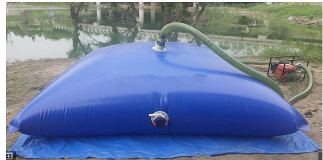
Рис. 5 – Складной накопитель мобильной установки Fig. 5 – Folding storage device for mobile installation
