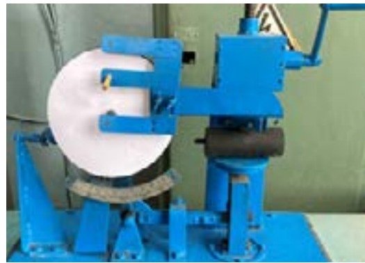
Рис. 3 – Процесс определения модуля упругости надувного элемента устройства для отделения корнеклубнеплодов от примесей Fig. 3 – The process of determining the modulus of elasticity of the inflatable element of the device for separating root crops from impurities
