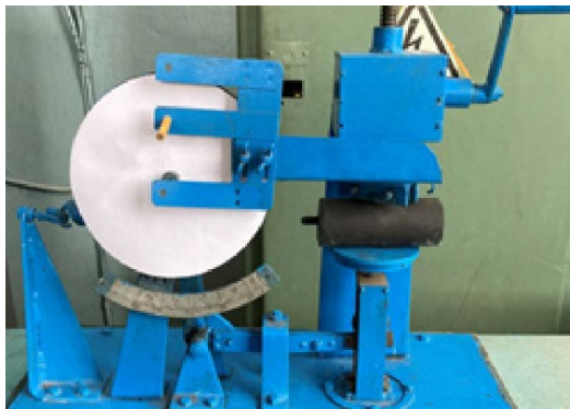
Рис. 3 – Процесс определения модуля упругости надувного элемента устройства для отделения корнеклубнеплодов от примесей
