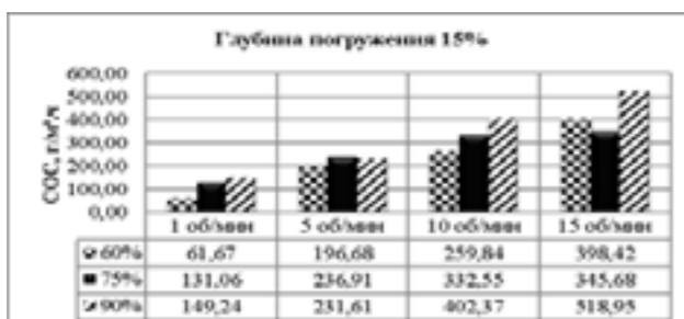
Рис. 5 – Зависимость СОС от объема загрузки Б при затоплении барабана на 15 % (иллюстрация авторов)
