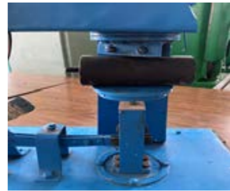
Рис. 3 – Процесс определения модуля упругости надувного элемента устройства для отделения корнеклубнеплодов от примесей Fig. 3 – The process of determining the modulus of elasticity of the inflatable element of the device for separating root crops from impurities
