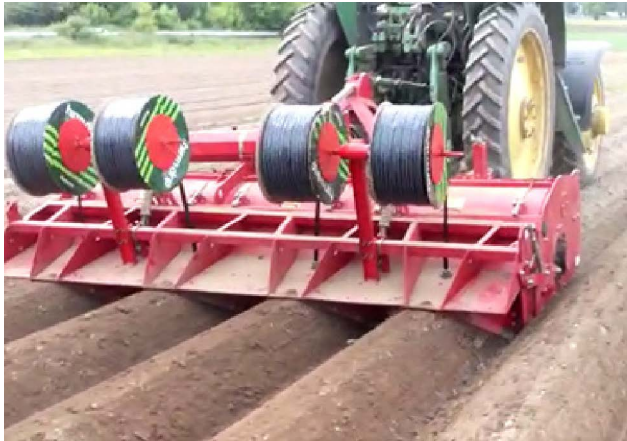
Рис. 3 – Укладчик капельной ленты на базе формователя гребней Grimme GF-75/4. Fig. 3 – Drip tape layerer based on the Grimme GF-75/4 ridge former.
