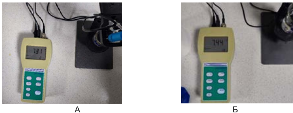
Рис. 1 – Значения pH раствора препарата Део-бактер меньшей (А) и большей (Б) концентраций Fig. 1 – The pH values of the solution of the Deo-bacter preparation of lower (A) and higher (B) concentrations
