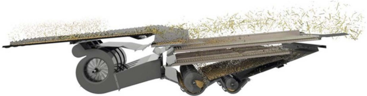
Рис. 6 – Конструкция вентилятора системы очистки зерноуборочного комбайна Claas. Fig. 6 – Fan design of the Claas combine harvester cleaning system.
