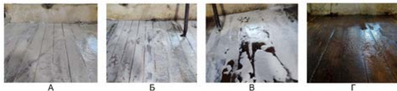
Рис. 1 – Эффективность пенообразования: А – «Оптимакс»; Б – «Део-бактер»; В – «Вирудез ПРО»; Г – «ДЕО-ХЛОР® ЛЮКС» Fig. 1 – Foaming efficiency: A – "Optimax"; B - "Deo-bakter"; V - "Virudez PRO"; G - "DEO-CHLORO® LUX"
