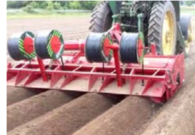
Рис. 3 – Укладчик капельной ленты на базе формователя гребней Grimme GF-75/4.
