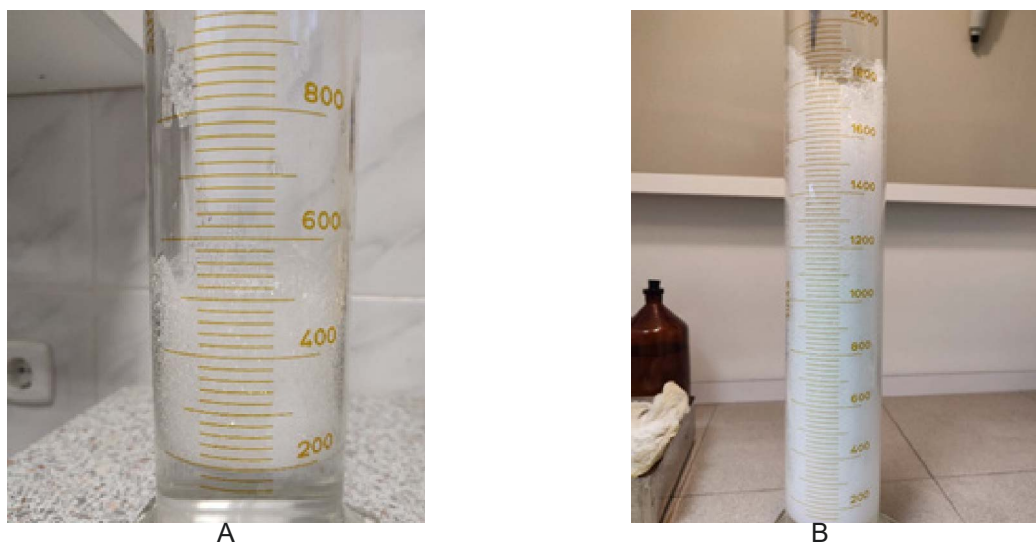
Рис. 5 – Кратность пены Вирудез PRO с меньшей (слева) и с большей (справа) концентрацией Fig. 5 – The multiplicity of Virudez PRO foam with lower (left) and higher (right) concentrations
