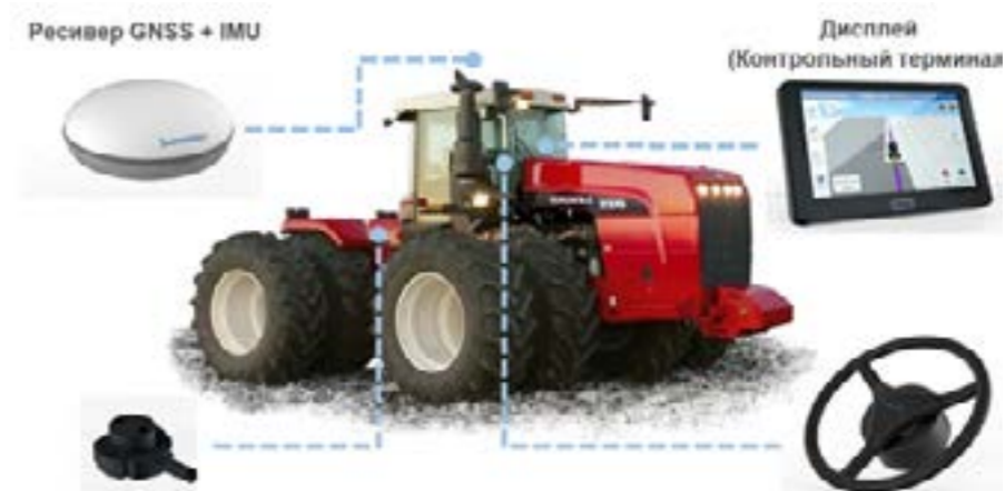
Рис. 1 – Основные компоненты системы параллельного вождения. Fig. 1 – Main components of the parallel driving system.
