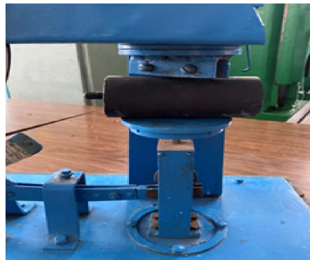
Рис. 3 – Процесс определения модуля упругости надувного элемента устройства для отделения корнеклубнеплодов от примесей
