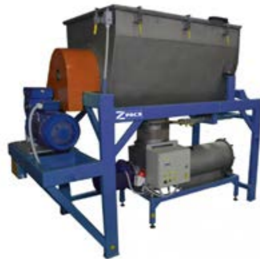
Рис. 5 – Просеиватель с возвратно-поступательным движением сита типа «Тарар» Fig. 5 – The sifter with reciprocating motion of the “Tarar” type sieve
