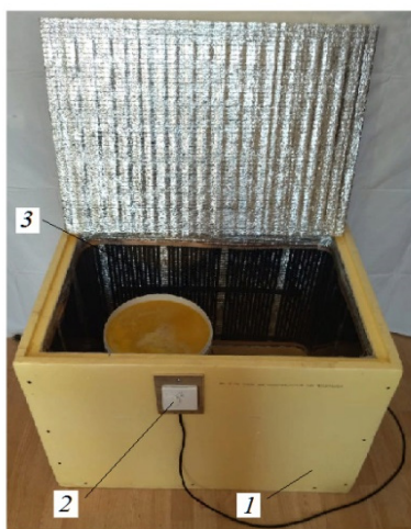
1 – корпус, 2 – инфракрасная нагревательная пленка, 3 – терморегулятор
