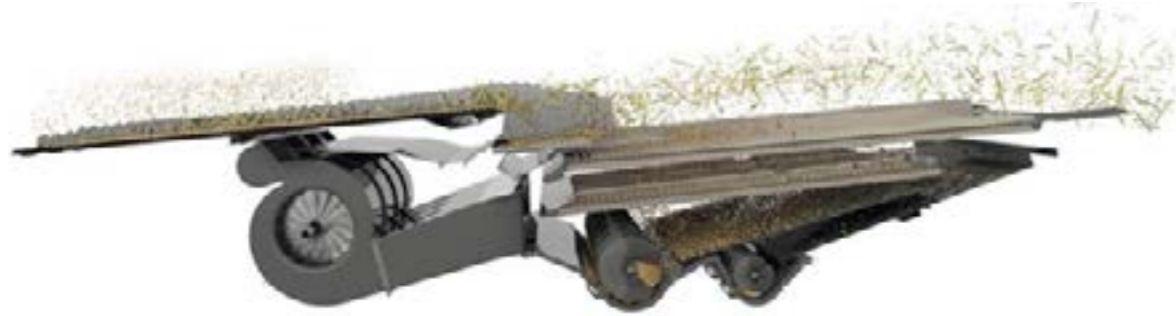
Рис. 6 – Конструкция вентилятора системы очистки зерноуборочного комбайна Claas. Fig. 6 – Fan design of the Claas combine harvester cleaning system.
