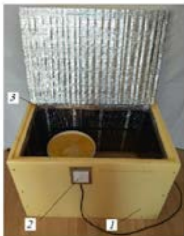
1 – корпус, 2 – инфракрасная нагревательная пленка, 3 – терморегулятор Рис. 10 – Термокамера для роспуска меда 1 – housing, 2 – infrared heating film, 3 – thermostat Fig. 10 – The thermal chamber for dissolving honey
