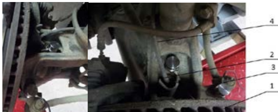
1 – вибродатчик рулевого наконечника; 2 – вибродатчик шаровой опоры; 3 – рулевой наконечник; 4 – тормозная трубка
