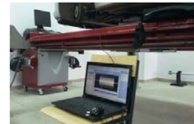
Рис. 4 – Преобразовательная и обрабатывающая часть диагностической установки Fig. 4 – Converting and processing part of the diagnostic installation
