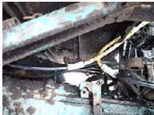
Рис. 5 – Врезка устройства СВЧ обработки в топливную систему дизеля Д-243 трактора МТЗ-80 Fig.5 – Embedding of the microwave processing device into the fuel system of the diesel engine D-243 of the MTZ-80 tractor
