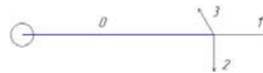
1 – направление струи вдоль консолей, 2 – направление струи перпендикулярно консолям, 3 – струи, направленные под углом к консоли Рис. 2 – Схема направления струй из насадок 1 – jet direction along the consoles, 2 – jet direction perpendicular to the consoles, 3 – jets directed at an angle to the console Fig. 2 – Flow diagram of the jets from the nozzles
