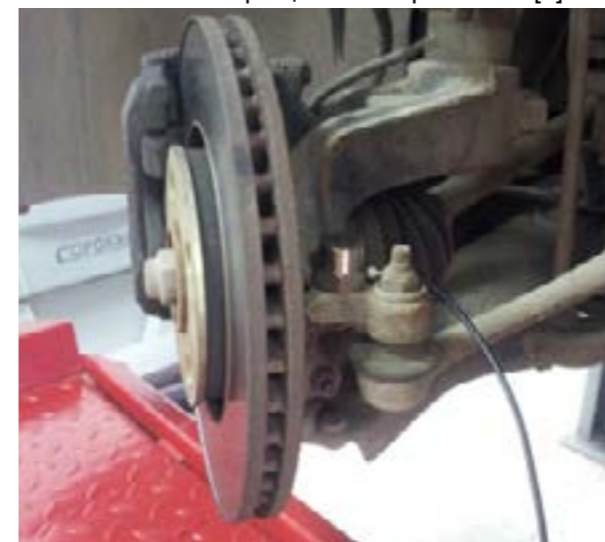
1 – вибродатчик, используемый для контроля состояния рулевого наконечника
