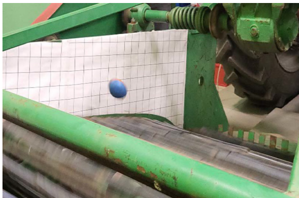
Рис. 7 – Полет радиоклубня «Tuber-Log» при исследовании динамического воздействия активного встряхивателя Fig. 7 – Flight of the Tuber-Log radio tube during the study of the dynamic impact of an active shaker
