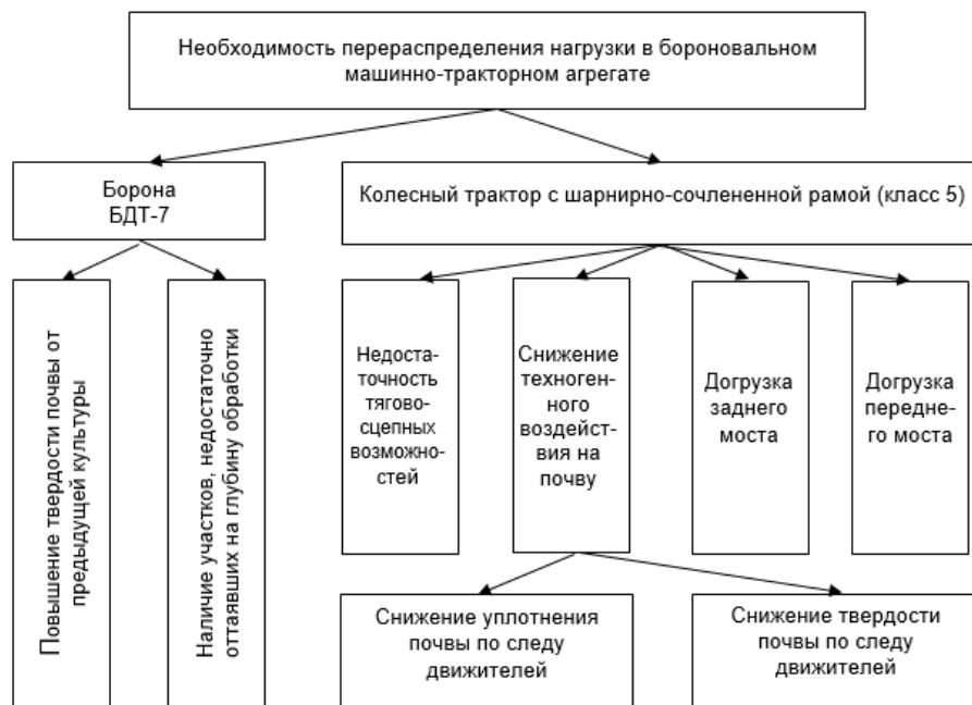
Рис. 1 – Необходимость перераспределения нагрузки в бороновальном машинно-тракторном агрегате (МТА)
