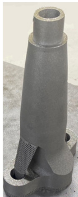
а – корпус; б – распылитель Рис.7 – Экспериментальный образец корпуса и распылителя разработанной форкамеры Fig.7 – An experimental sample of the body and sprayer of the developed pre-chamber
