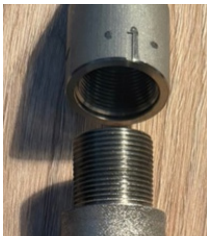
Рис.9 – Выполненная на корпусе и распылителе резьба Fig.9 – The thread made on the body and the sprayer
