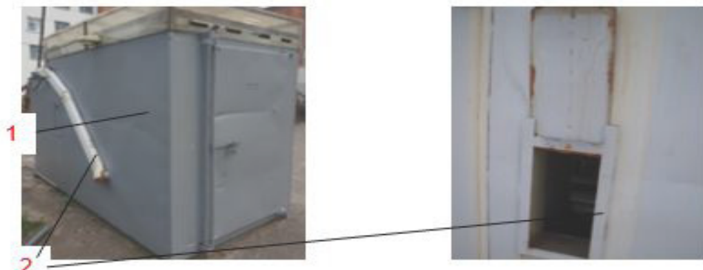
1 – основной модуль сушилки; 2 – смотровое окно
