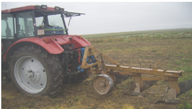
Рис. 1 – Состав МТА на базе трактора Беларусь – 922 с плугом ПЛН-3-35 Fig. 1 – MTF composition based on the Belarus-922 tractor with the PLN-3-35 plow
