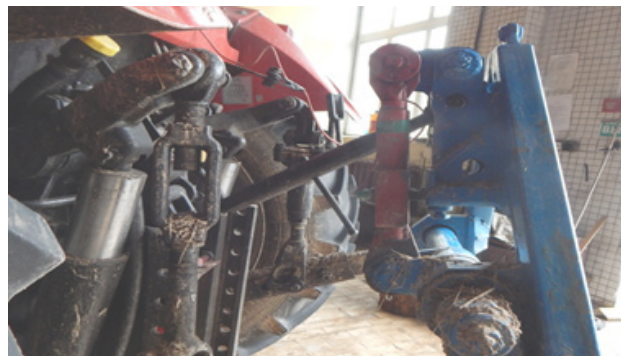
Рис. 2 – Динамометрическая автосцепка, установленная на тягово-сцепном устройстве трактора при испытаниях Fig. 2 – Torque automatic coupling installed on the tractor drawbar during testing
