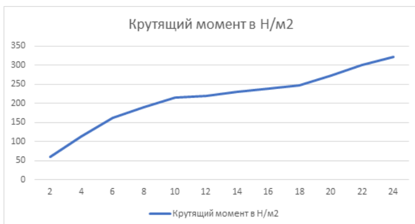
Рис. 7 - Диаграмма крутящего момента в зависимости от глубины хода Fig. 7 - Torque diagram depending on stroke depth
