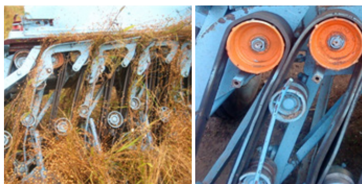
Рис. 6 – Рабочий процесс льнотеребильного аппарата с продольными ручьями и шкивами, снабженными цилиндрическими выступами
