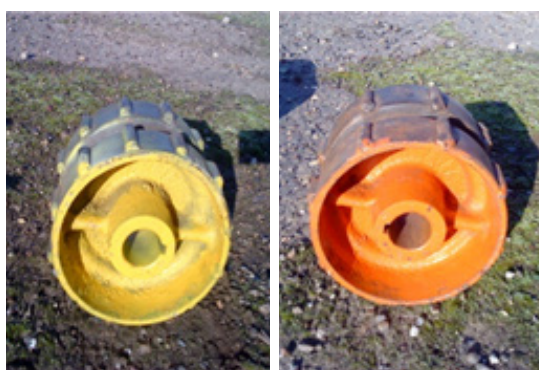
Рис. 5 – Цилиндрические стержни (выступы) на рабочей поверхности ведущего шкива
