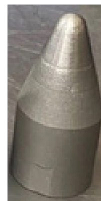
а – корпус; б – распылитель Рис.7 – Экспериментальный образец корпуса и распылителя разработанной форкамеры Fig.7 – An experimental sample of the body and sprayer of the developed pre-chamber
