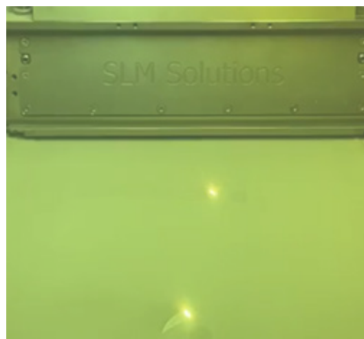
а – печать корпуса; б – печать распылителя Рис.6 – Процесс печати разработанной форкамеры
