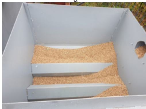
а – начальный момент работы; б – характерная картина истечения зерна
