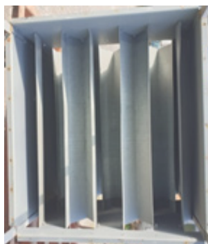
Рис. 3 – Вид сушильной шахты снизу Fig. 3 – Bottom view of the drying shaft
