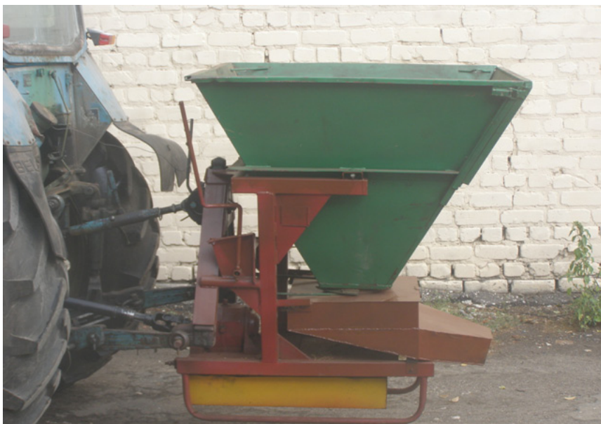
Рис. 2 – Механический адаптер, агрегатированный с МТЗ-80
