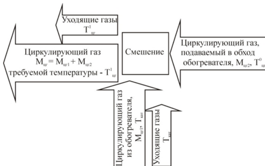
Рис. 3 – Схема II смешения основной части циркулирующего газа и выходящих из обогревателя газов
