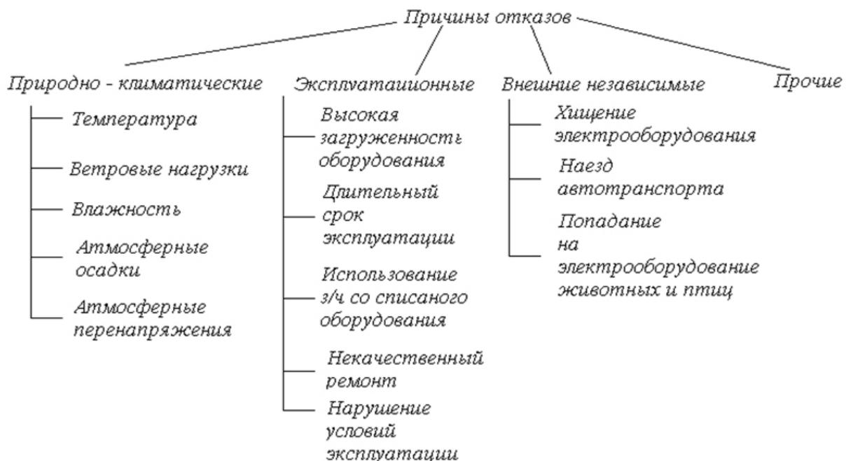
Рисунок 1 – Основные причины отказов электрооборудования напряжением 0,38...10 кВ.
