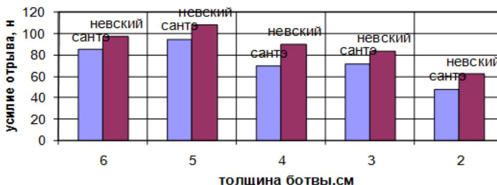
Рис. 2 – Зависимость усилия отрыва от размеров ботвы
