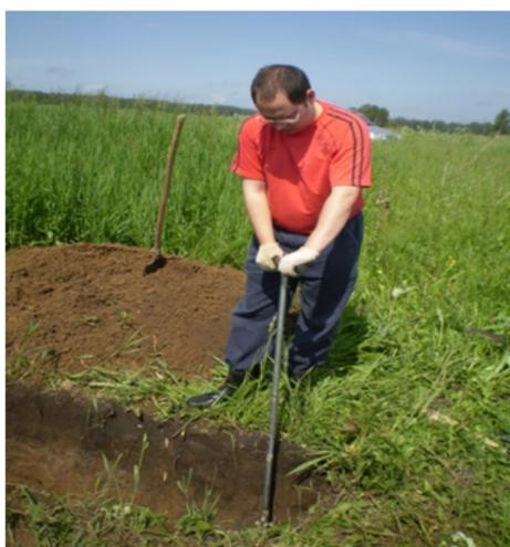
Рис. 3 – Отбор проб почвы почвенным буром
