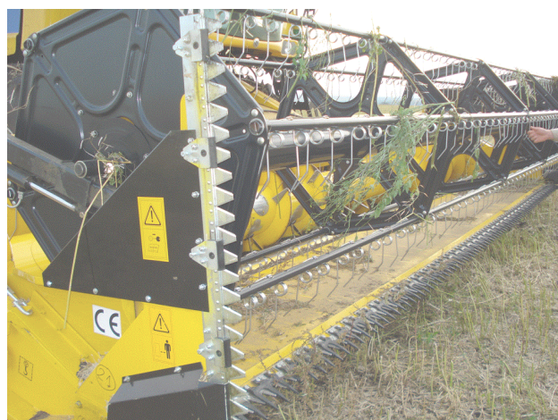
Рис. 4 – Активные боковые делители «рапсовых столов» на комбайне New Holland CS-6090 в ООО «АНП Скопинская Нива»
