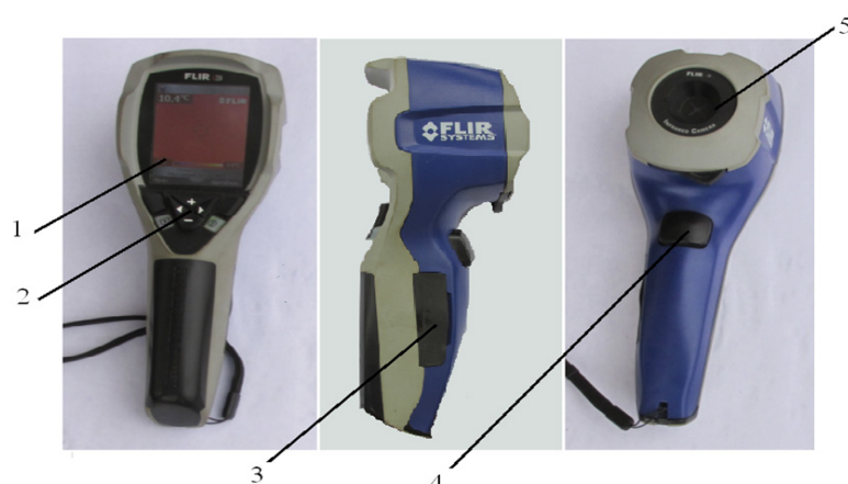
1 – экран; 2 – пульт управления; 3 – гнездо для подключения шлейфа; 4 – кнопка фиксации изображения; 5 – инфракрасная камера
