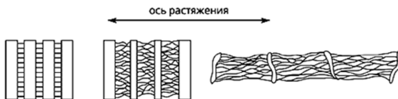
Рис. 3 – Схема, иллюстрирующая коллапс структуры полимера, происходящий при больших значениях деформации в адсорбционно-активной жидкости, на различных стадиях растяжения
