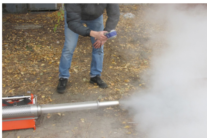
Рис. 2– Исследования топографии температурных полей облака аэрозоля от генератора горячего тумана
