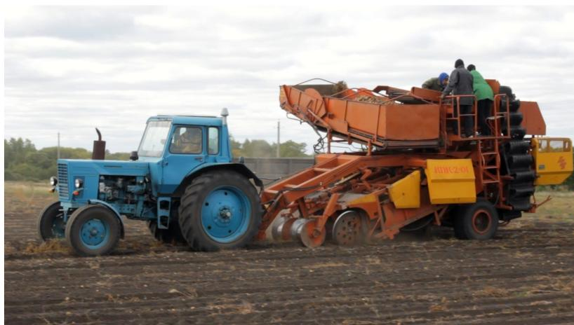
Рисунок 1 — Общий вид уборочного агрегата с усовершенствованным комбайном КПК-2-01
