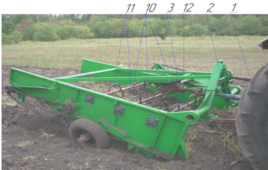
1 – трактор; 2 – карданный вал; 3 – редуктор; 10 – приводные валы; 11 – рабочие элементы; 12 – конвейер.
