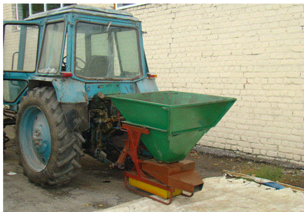
Рис. 5 – Испытания устройства для подавления жизненной активности хлебных вредителей на базе ГНУ ВНИИМС г. Рязань
