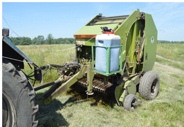
Рис. 1 – Общий вид пресс-подборщика с устройством для внесения консервирующих препаратов
