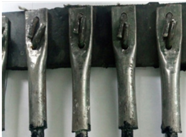
Рис. 1– Общий вид металлических замков, закреплённых на приводных ремнях Fig.1– General view of metal locks attached to drive belts
