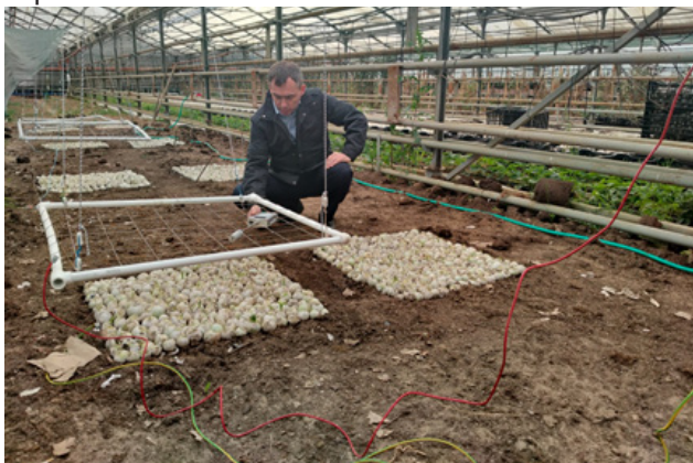
Рис. 3 – Отладка стимуляции растений электростатическим полем Fig.3 – Calibration plant stimulation with an electrostatic field
