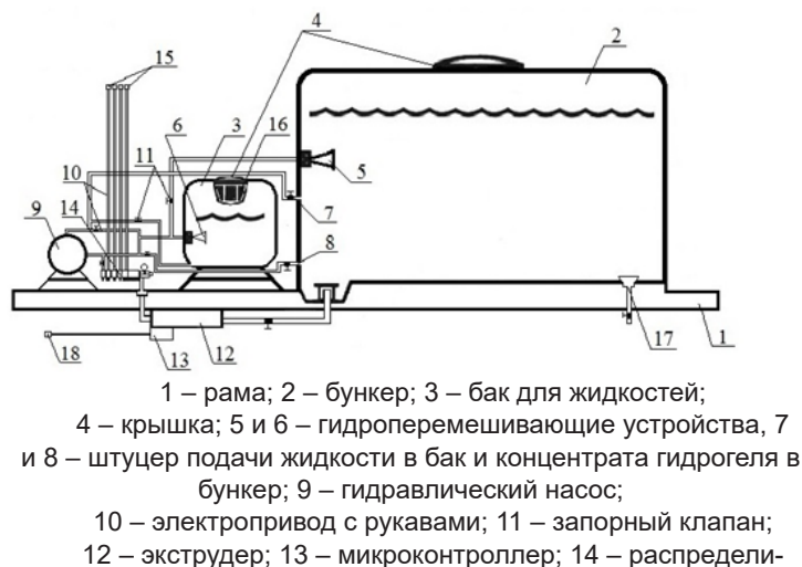
Рис. – Модуль для внутрипочвенного внесения гидрогеля
