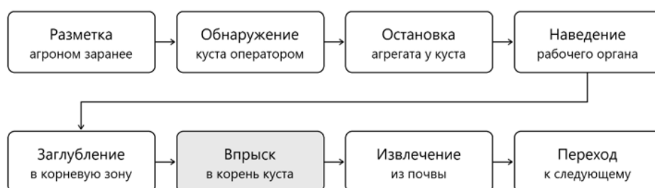
Рис. 5 – Технологическая схема цикла обработки одного растения Fig. 5 – Technological scheme of the single-plant treatment cycle
