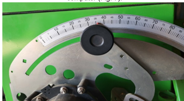
Рис. 3 – Рукоятка-корректор ручного управления нормой внесения минерального удобрения Fig. 3 – Handle-corrector for manual control of the application rate of mineral fertilizer
