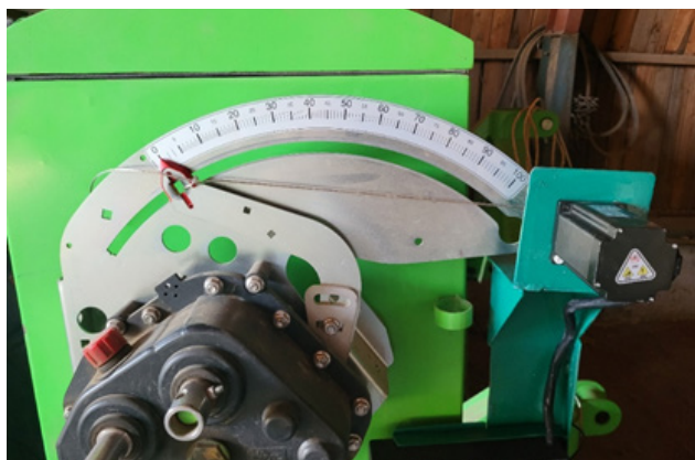
Рис. 8 – Привод рукоятки-корректора ручного управления нормой внесения минерального удобрений Fig. 8 – Drive of the handle - manual control of the rate of application of mineral fertilizers
